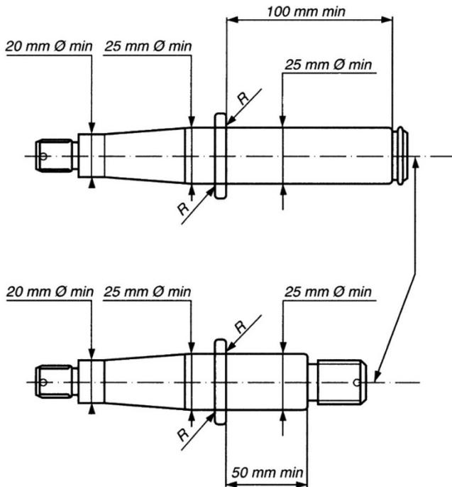
Abbildung R – Achs- und Radaufhängung bei Bahn-Gespannen
