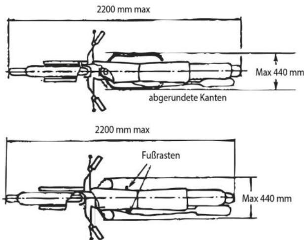
Abbildung K – Langbahn-Motorrad
